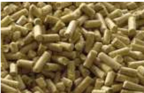
Les **granulés de bois** sont fabriqués avec de la sciure issue de l’industrie du bois : ces sciures sont transformées en granulés par pressage si elles sont sèches. Elles sont préalablement séchées avant compression si elles sont humides. Dans les deux cas, les granulés ne comportent pas d’additifs. Le granulé de bois est un produit beaucoup plus homogène que la plaquette, donc plus facilement utilisable, mais il nécessite plus d’énergie pour sa fabrication.
