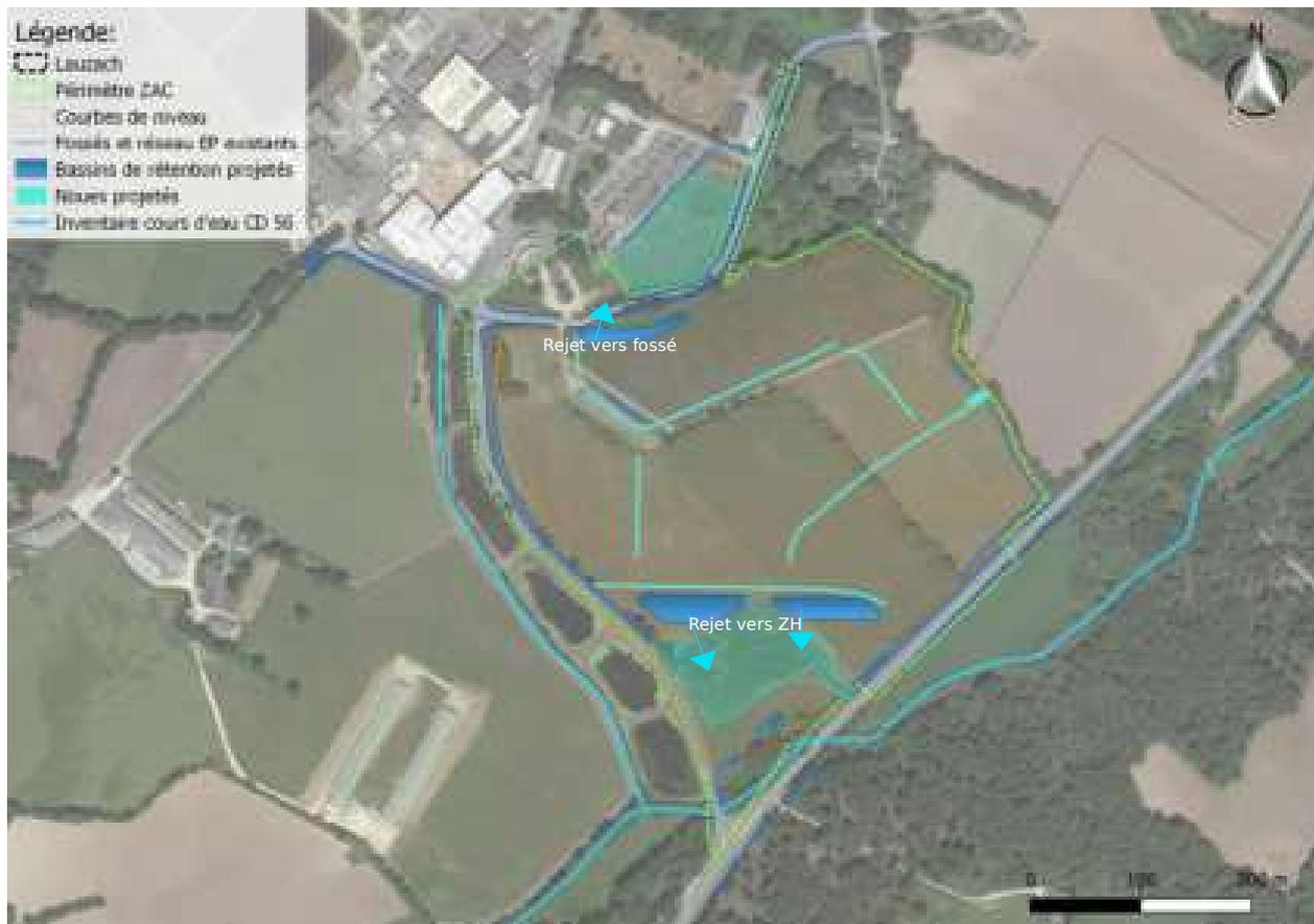
153 Schéma de principe de fonctionnement de gestion des eaux pluviales (source : Quarta ; GLEMAREC ; levé topographique Quarta ; BDD CD 56 ; fond : Google satellite)
