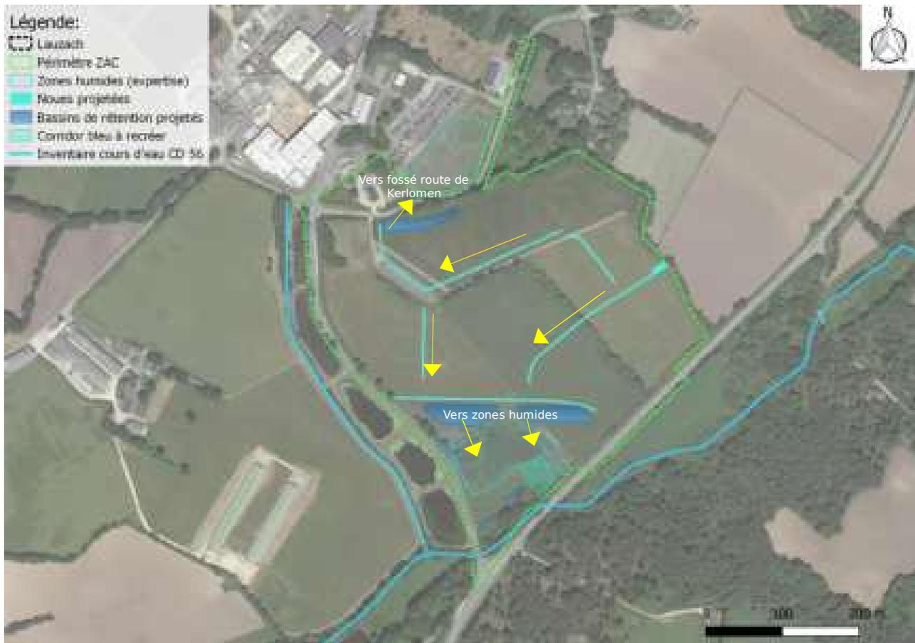
133 Schéma de principe du fonctionnement des dispositifs de gestion des eaux pluviales et de préservation des zones humides sur le PA (source : Quarta ; GLEMAREC ; BDD CD 56 ; fond : Google satellite)
