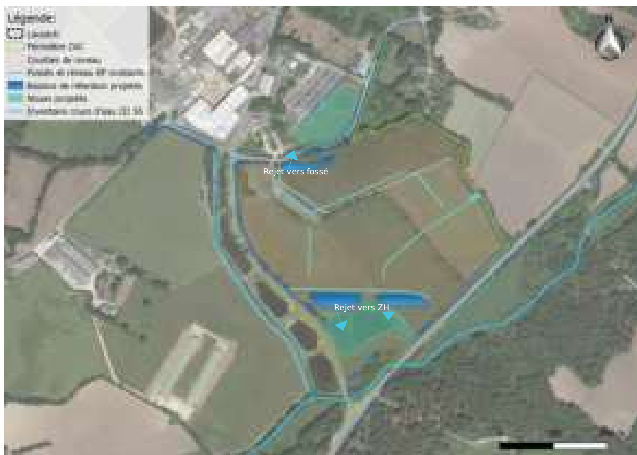
158 Schéma de principe de fonctionnement de gestion des eaux pluviales (source : Quarta ; GLEMAREC ; levé topographique Quarta ; BDD CD 56 ; fond : Google satellite)
