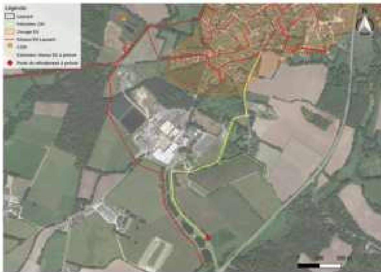
124 Raccordement envisagé au réseau eaux usées
