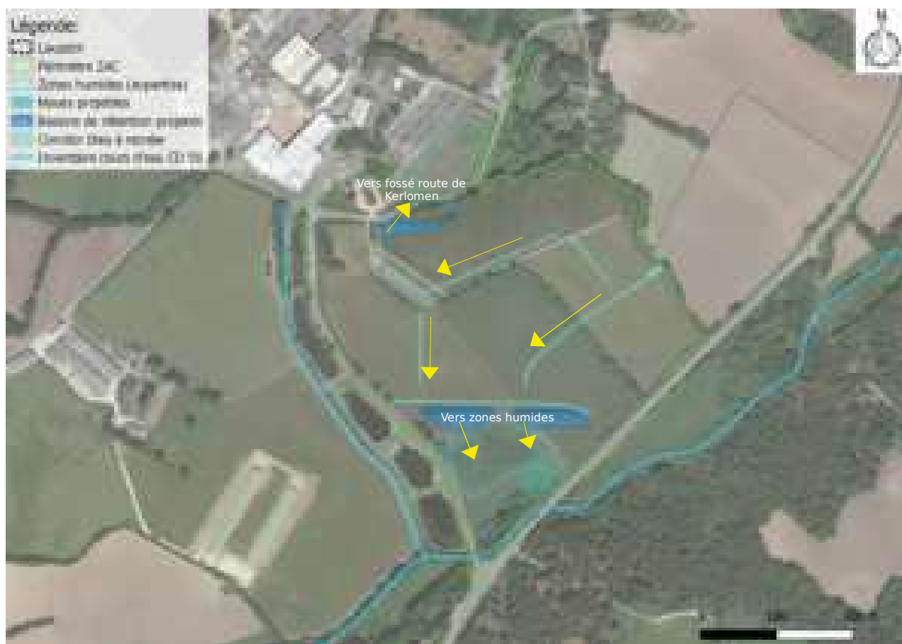
138 Schéma de principe du fonctionnement des dispositifs de gestion des eaux pluviales et de préservation des zones humides sur le PA (source : Quarta ; GLEMAREC ; BDD CD 56 ; fond : Google satellite)
