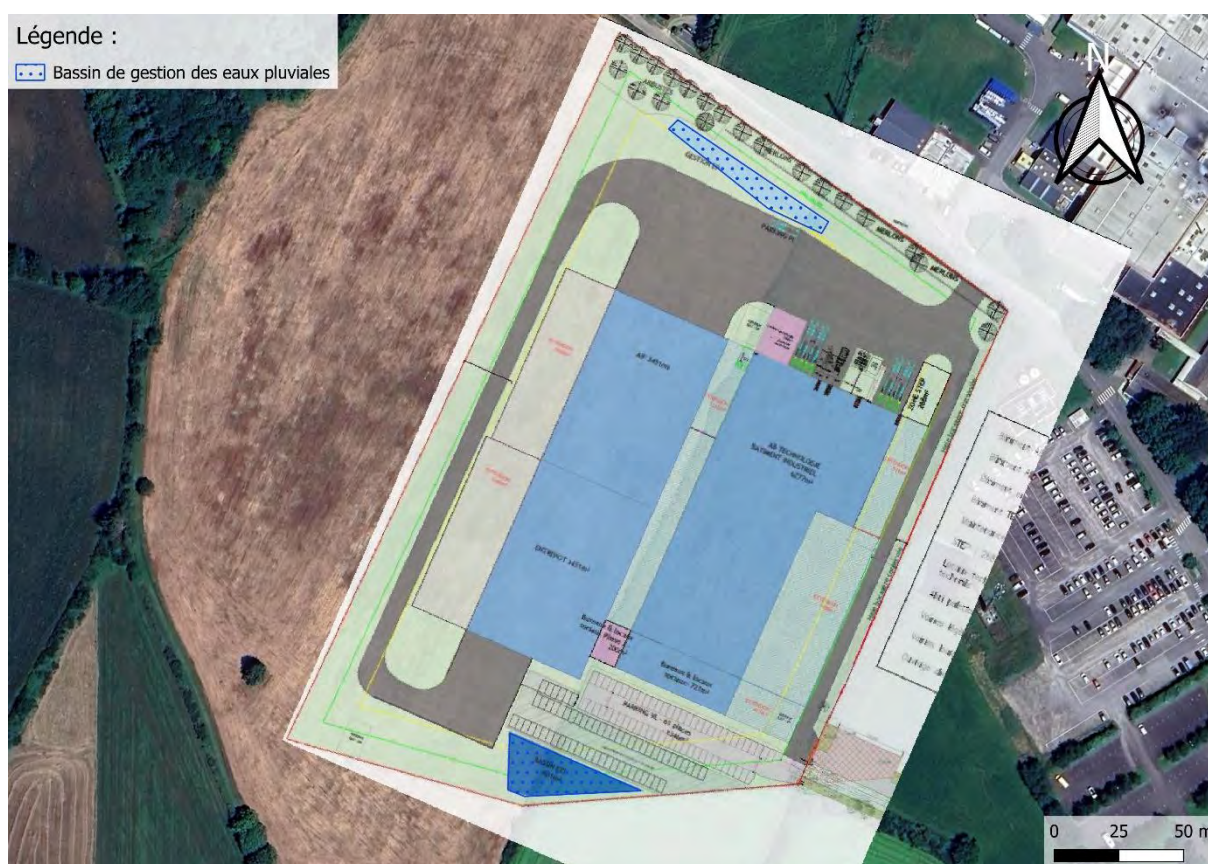
Illustration N°87: Principe de gestion des eaux pluviales (Source : Quarta ; Fonds : Google satellite, plan masse, décembre 2024, Atelier d'Ys)
