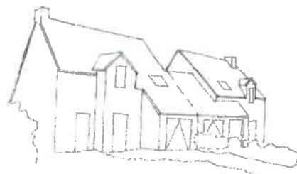
Raccord de toitures mitoyennes maîtrisé Création de continuité par la ligne d'égout
