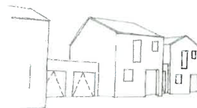
Garage à toiture terrasse en mitoyenneté
