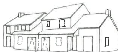
Raccord de toitures mitoyennes maîtrisé Création de continuité par la ligne d'égout
